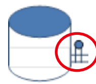
タンク配管への緊急遮断弁の設置
