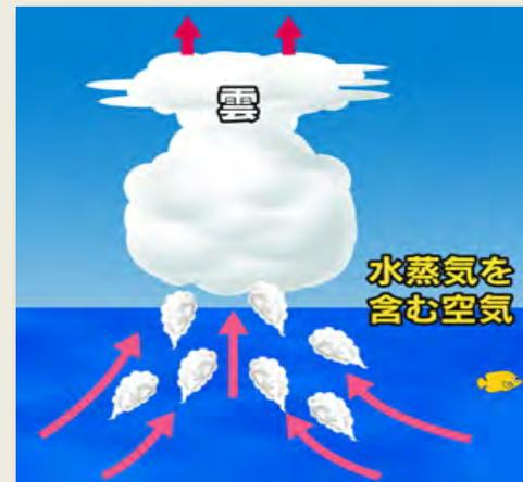
これが繰り返されていくうちに、小さな渦は大きな渦にまで発達する。これが熱帯低気圧の発生です。熱帯低気圧が発達すると台風となる。同じ熱帯でも、大陸には熱帯低気圧はできません。海から放出される莫大な水蒸気が台風のエネルギー源であるからである。
